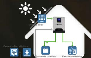
En esta prioridad las cargas serán alimentadas por los paneles solares y/o las baterías. El suministro en corriente alterna será activado al detectar que la energía solar no está disponible o que el voltaje de las baterías descendió al valor programado (es necesario llevar a cabo la configuración descrita en el manual).
